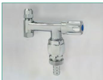
En laiton matricé, poli chromé avec clapet de retenu, avec ventouse incorporée et raccord nez. À l'extrémité de l' allonge se trouve un raccord cône en laiton sertir 3/8" (10 mm). Ce robinet est raccordé sur un robinet équerre monté au préalable, conditionné une unité par carton
